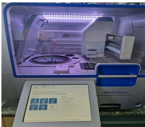
Figura 10. Stație de lucru robotizată pentru extracție acizilor nucleici din dotarea SCDP Bistrița
