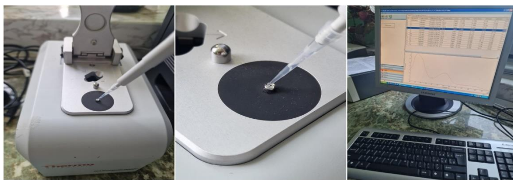
Figura 12. Spectrofotometru NanoDrop 2000c pentru cuantificarea purității acizilor nucleici (SCDP Bistrița)
