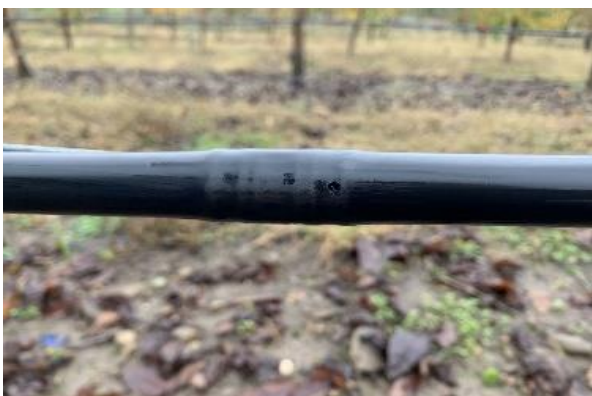
Figura 39. Tub de picurare cu picurator cilindric, cu presiune compensată (sursa:original)
