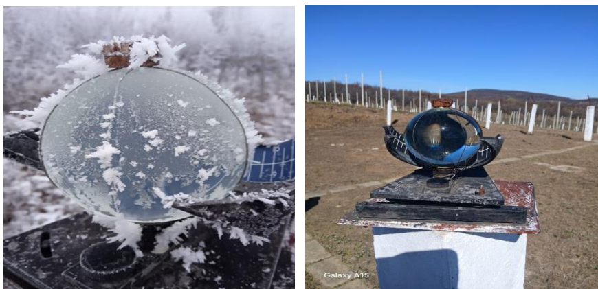
Figura 19. Heliograful Fuess, măsurarea duratei orelor de strălucire a soarelui (iarna și primăvara) (sursa:original)
