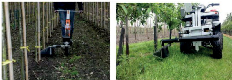
Figura 1. Echipamente specific de aplicare ULV a erbicidelor biologice în plantațiile pomicole (după Butac și colab., 2021)
