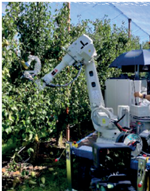
Figura 7. Robot multifuncțional The Next fruit 4.0
